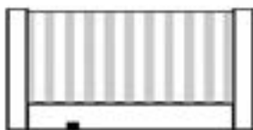
przejścia w podmurówce
